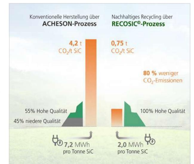
CO<sub>2</sub>-armes Recycling von Siliciumcarbid im RECOSIC®-Verfahren – entwickelt vom Fraunhofer IKTS und der ESK-SiC GmbH – im Vergleich zum energieintensiven ACHESON-Prozess © Fraunhofer IKTS
